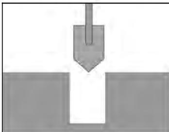
Für jedes Standrohr ein Loch mit einer Tiefe von ca. 50 cm ausheben. Hinweis: Für kleine Anlagen mit nur 2 Briefkästen, empfiehlt es sich für die Stabilität ein durchgehendes Fundament vorzubereiten.
