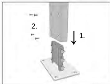
Die im Lieferumfang separat beigelegten Fußplatten an die Enden der Rohre stecken.
