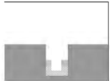
Anlage in die Grube stellen, grade ausrichten und abstützen.
