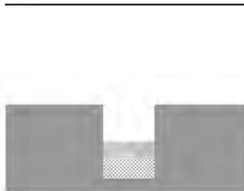
Gruben mit einem Teil Kies und einem Teil Beton füllen.
